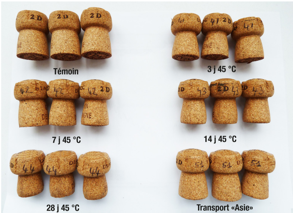
Photo 1. Aspect des bouchons après débouchage de bouteilles ayant subi un traitement à 45 °C (pendant 3 à 28 jours) et de type "Transport Asie".
